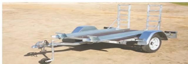
Rails porte quad en option + rampe de montée
