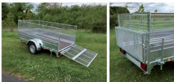
RE250 F130 avec rehausse grillagée de 50 cm, bécilles de stabilité arrière et rampe pliante 1,10 m galvanisée à chaud
