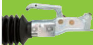
Dispositif de haute sécurité : une platine de chaque côté de la tête viendra fixer le SAFETY mais en plus rendra inaccessible la boulonnerie de la tête.
