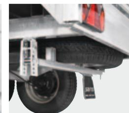
6 Roue de secours / Support roue de secours
