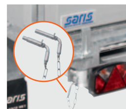
8 Tri-bennes avec sécurité de déformation de châssis
