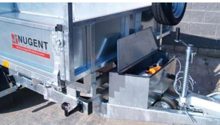
Boîte de rangement verrouillable pour la batterie et la télécommande de la benne.
